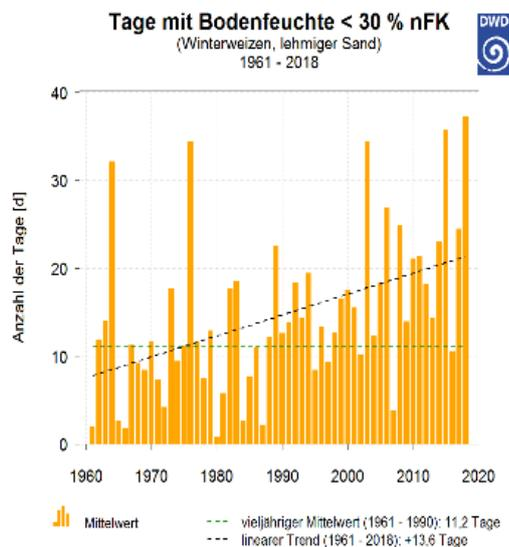
Abbildung y: Jährliche Anzahl der Tage mit Bodenfeuchtwerten unter 30 % nFK für Winterweizen auf leichtem Boden (lehmiger Sand) für Deutschland
