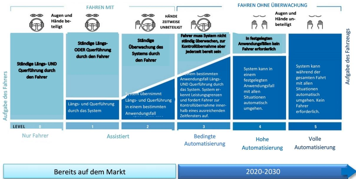
Fahrerunterstützende Fahrzeuge sind bereits auf dem EU-Markt verfügbar (Stufen 1 und 2) und automatisierte Fahrzeuge, die in bestimmten Fahrsituationen selbst fahren können (Stufen 3 und 4), werden gerade getestet und sollen ab 2020 verfügbar sein.<sup>12</sup>
